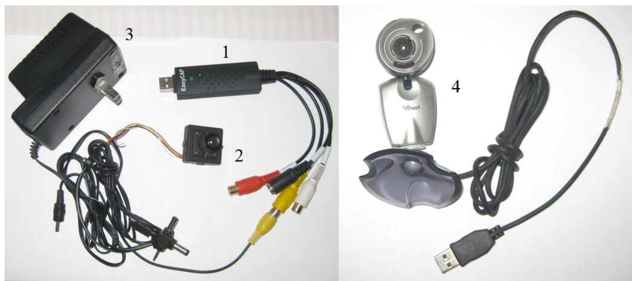
Figura 34. 1-Easecap, 2- câmera Sony, 3- Fonte de alimentação e 4 – Webcam Trust.
