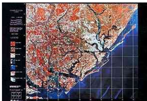
Figura 2. Exemplo de Ortofotomapa – Orto-imagem (aerofoto ou imagem de satélite) com informações de coordenadas e legenda explicativa.
