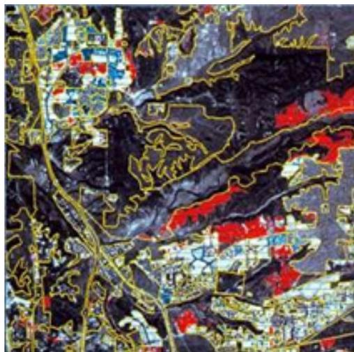
Figura 6: Exemplo de Carta Temática (Uso do Solo na Zona da Mata em PE) construída a partir de Imagens de satélite (SPOT) integrada a dados do GIS.
