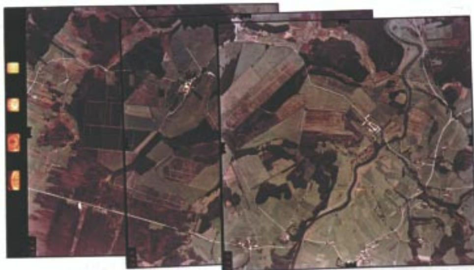
Figura 44. Sequência de modelos estereoscópicos utilizados em aerofotogrametria.
