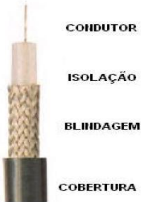
Figura 1 - Estrutura do cabo coaxial
